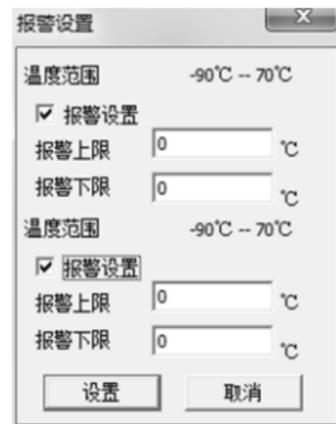
报警方式说明:报警后,以10秒间隔连续报警30次,如果测量值一直处于超限状态,约10分钟加上记录间隔时间以后,再以10秒间隔连续报警30次,以此循环。若测量值恢复正常,并且未完成30次报警,需要通过任意按键进行手动取消报警。
